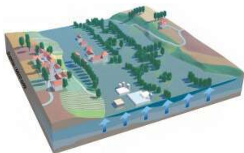
Remontée de nappe ▼
